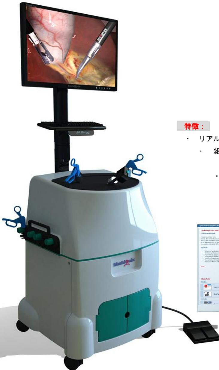
腹腔鏡下手術トレーニングシミュレータ LAP Mentor II は、最先端技術で実際の腹腔鏡下手術における視覚と触覚を擬似化しておりリアルなトレーニングが可能です。
